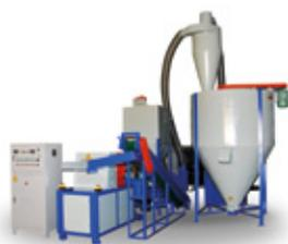
Предназначено для активации и производства специальных минеральных вяжущих. Применяется в составе технологических линий автоматизированного и ручного управления.
