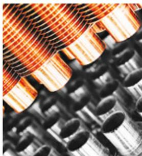
Способны методом поперечно-винтовой прокатки без подогрева производить моно- и биметаллические трубы. Этот способ позволяет получать наиболее эффективные по теплопередаче и экономичные в изготовлении трубы с винтовым оребрением. Благодаря освоению прокатки ребристых труб широкое применение в теплообменной аппаратуре получили алюминиевые трубы взамен труб из медных сплавов.
