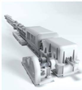
Предназначены для получения трубной продукции с гарантированными механическими и технологическими характеристиками, точными геометрическими размерами и качественной поверхностью. «ВНИИМЕТМАШ» предлагает станы для производства труб из заготовок различного диаметра и толщины стенок.
