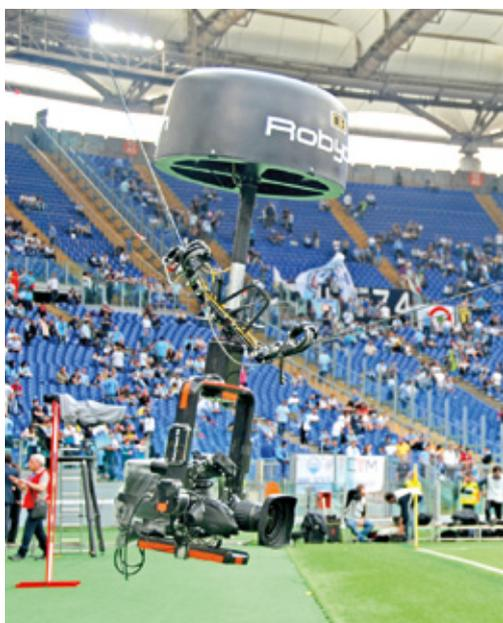
Система надежных синтетических тросов, установленная на четырех опорах, при помощи мощных, соединенных в единую роботизированную систему реального времени, электролебедок дает возможность свободно перемещать в трехмерном пространстве гиросtabilизированную головку, позволяющую применять камеры с длиннофокусной оптикой и отслеживать объекты плавно, без «тряски». Головка дает возможность применять современные камеры для телевизионного вещания и записи в формате HD.
