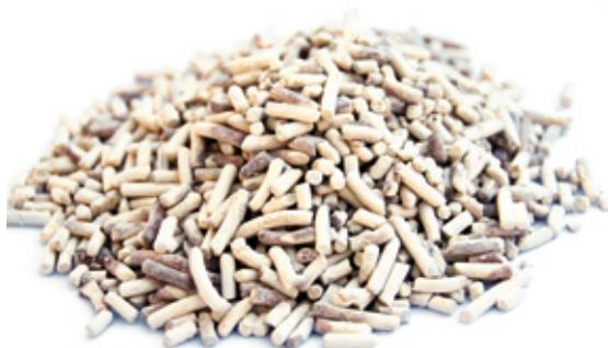
Очистка достигается за счет собственных запатентованных катализаторов. Ключевая стадия процесса состоит в пропускании газа через слой катализатора в стандартном оборудовании.
